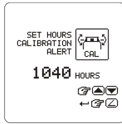
Einstellung der Kalibrieralarmfunktion
