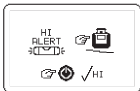
Gerätehöhenalarm-Anzeigebild (Elevation H.I. Alert)
