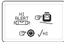
Alarm wysokości (H.I.) Ekran alarmowy
