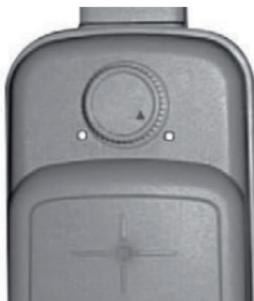
1. Ruotare la manopola del contenitore delle batterie e posizionare il marchio ▼ punto su **UNLOCK**, tirare fuori la custodia delle batterie.
