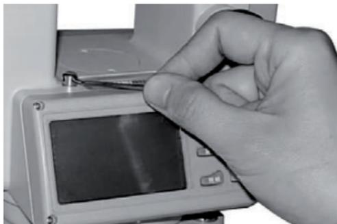
1. Regolare la vite di regolazione della bolla in modo che la bolla si muova verso il centro del tubo per la metà del fuori centro.
