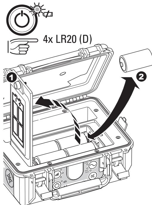
1. Отверните крепление и снимите крышку.
