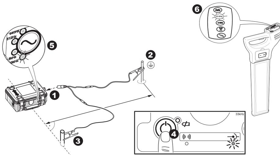
1. Подключите кабель Генератора к соединительному гнезду.
