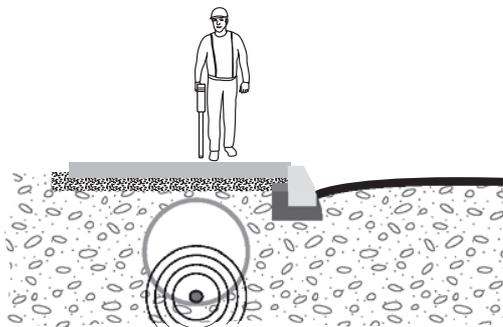
Будьте особенно внимательны, когда сигнал излучается зондом, лежащим в трубе большого диаметра!
