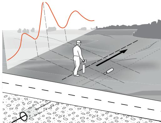
1. Следуйте вдоль направления коммуникации и наблюдайте за дисплеем. Показатель мощности сигнала будет подниматься и опускаться, реагируя на ложный отраженный сигнал непосредственно позади Зонда; максимальный сигнал будет отмечен непосредственно над Зондом, после чего опять будет отмечен ложный сигнал спереди Зонда. Численное значение мощности сигнала будет максимальным при определении максимального сигнала.
