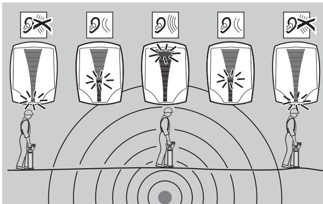
Вернитесь к участку с максимальным сигналом. Если индикатор мощности сигнала показывает максимальное значение, то коммуникация пролегает прямо под Трассоискателем. Звуковой сигнал автоматически настроится, способствуя, таким образом, точному нахождению коммуникации, а когда значение на индикаторе упадет до минимального, автоматически вернется к предыдущим настройкам.
