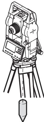
Direction de la gravité. Le compensateur définit la direction de la gravité à l'intérieur de l'instrument.
